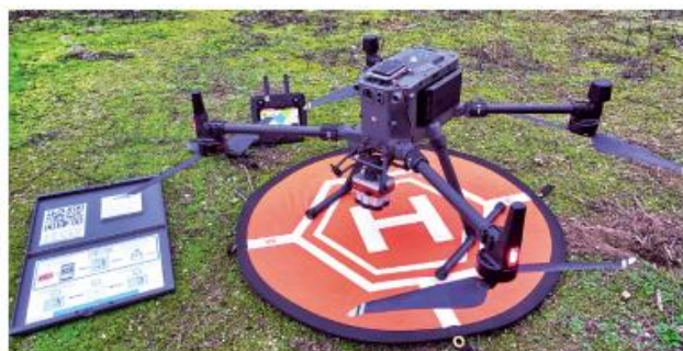
Figura 3. Configuración Matrice 300RTK con el sensor multiespectral abordo.
