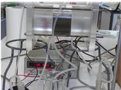
**Figura 4:** Montaje experimental del método electrodialítico
